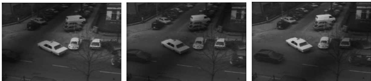
Figure 2 : 3 images de la séquence Taxi altérées par un voile sombre qui traverse l’image en diagonale (flicker local).
